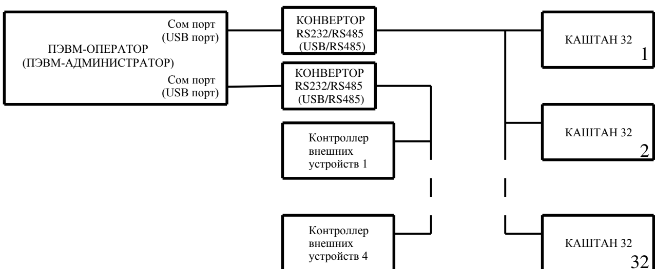
Рисунок 2.11.б - Схема подключения ЭВМ к КР через конвертор USB/RS485
