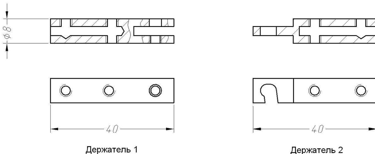
Соединитель изготовлен из латуни марки ЛС-59-1 или Л63 с покрытием О-Ви (99,5) 9.
