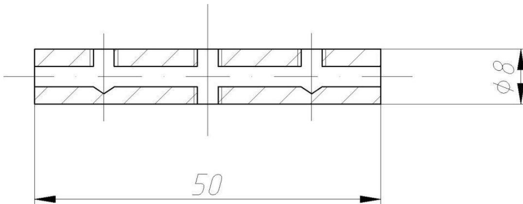
Соединитель изготовлен из латуни марки ЛС-59-1 или Л63 с покрытием О-Ви (99,5) 9.
